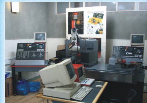
Sistem flexibil de fabricație prin comandă numerică asistat de calculator
