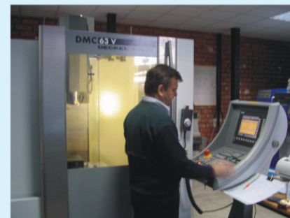
Centru de prelucrare cu 4 axe comandate numeric simultan
